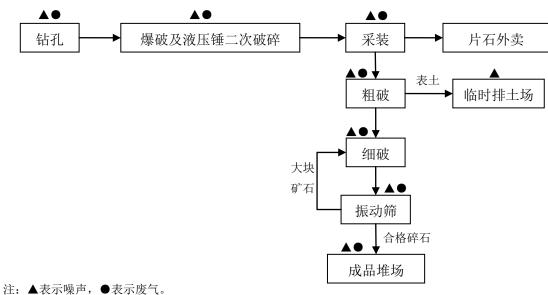
图 2.5-1 矿山生产工艺流程及产污环节图
