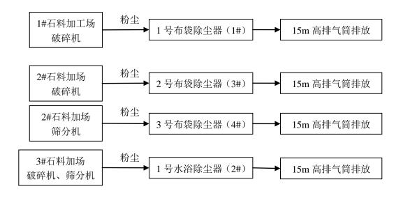
图 7.1-1 废气处理流程示意图
