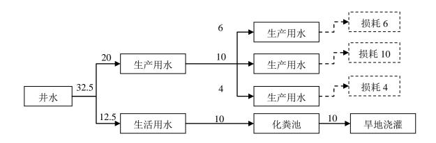
图 2.3-1 项目用水平衡图 (m³/d)
