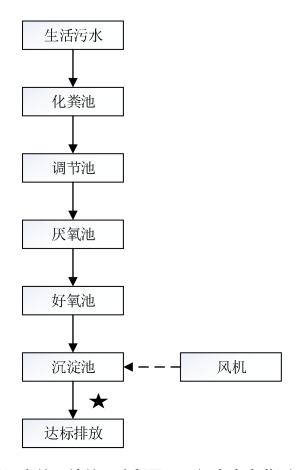
图 3-1 生活污水处理站处理流程图 ★ 为废水监测点位
