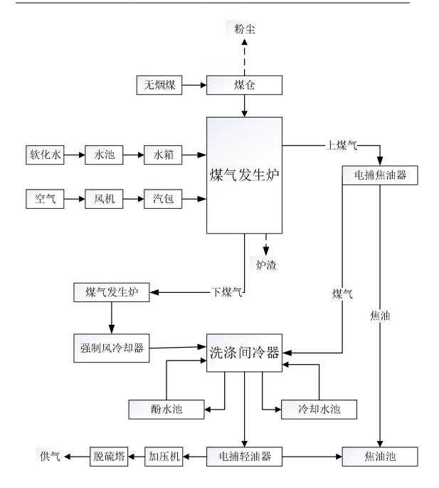
图 2-2 煤气发生炉工艺流程及产污节点图
