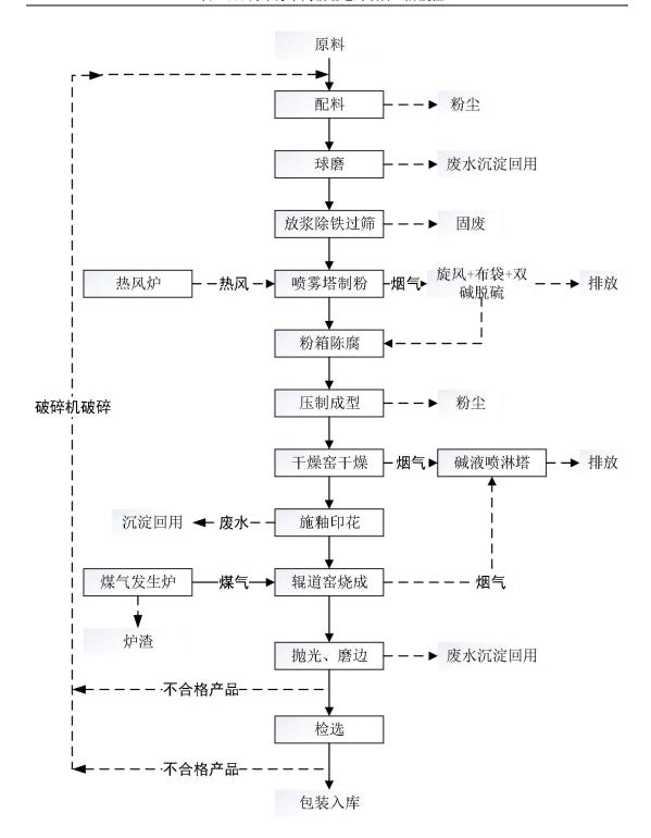
图 2-1 墙地砖生产工艺流程及产污节点图
