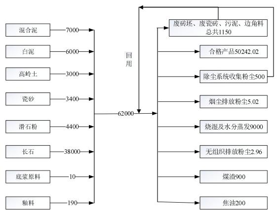
图 2-4 物料平衡图(单位: t/a)
